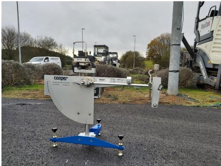
Figura 5. Ensayo con péndulo británico. |
