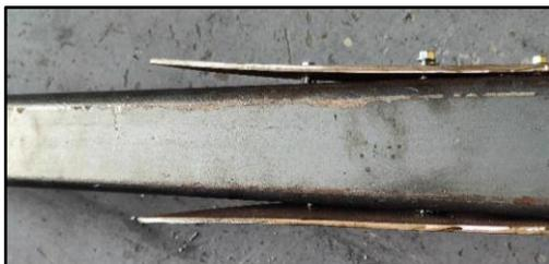
Figura 19. Separación de los perfiles de la Probeta 1
