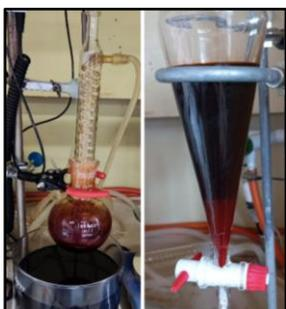
Figura 5. Izda. – Montaje equipo de reacción / Dcha. – Decantación y separación FAME y glicerina.
