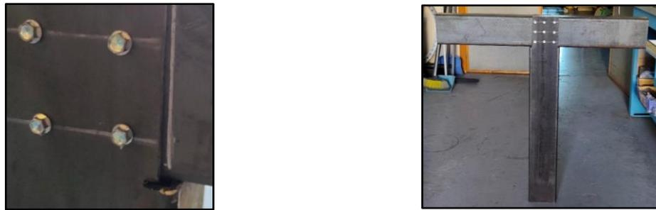
Figura 34. Probeta 2 de la Unión Viga Pilar
