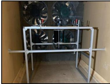
Figura 3. Modelo de turbina hidrocínética ubicada en cámara de pruebas
