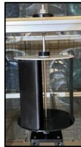
Figura 5. Generador de imanes permanentes acoplado a la turbina
