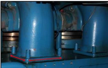
Figura 2. Toma de medidas del tramo de tubería de aire de carga que comunica el colector de dentro del bloque con la culata del cilindro.
