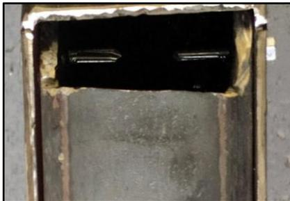
Figura 23. Separación Superior de los Perfiles
