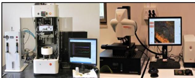
Figura 7. Izquierda – Tribómetro CETR UMT 3; Derecha – Microscopio Leica DCM 3D.
