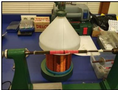
*Figura 1. Tareas de bobinado de circuitos secundarios durante las primeras fases del proyecto*
