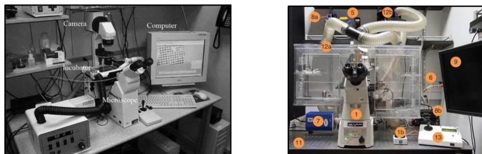
Figura 1. Dos ejemplos de "Microscopio Time-lapse".
