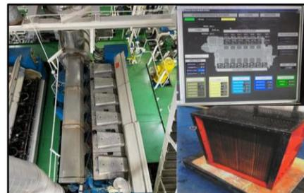
Figura 3. Fotos buque Cristina Masaveu. Izquierda plano superior motor con las tapas de las bombas de combustible a cada cilindro levantadas por mantenimiento, derecha superior pantalla de parámetros del motor en ordenador del control de máquinas, y derecha inferior enfriador aire de carga sustraído para limpieza.
