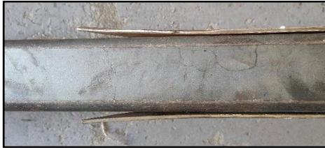
Figura 22. Separación entre Perfiles de la Probeta 2
