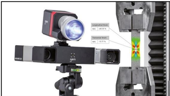
Figura 41. Equipo ARAMIS empleado para los Ensayos
