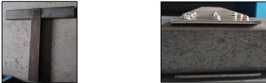
Figura 33. Probeta 1 de la Unión Viga-Pilar
