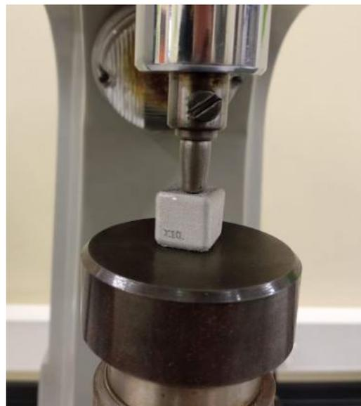
Figura 97. Ensayo de dureza Rockwell B en la probeta
