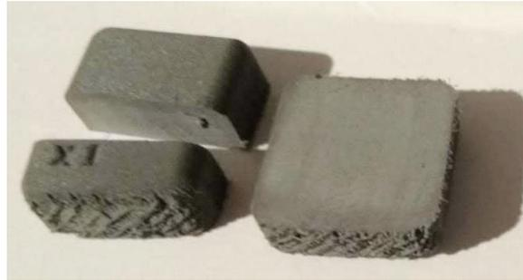
*Figura 3. Probeta en verde cortada con la tronzadora*
