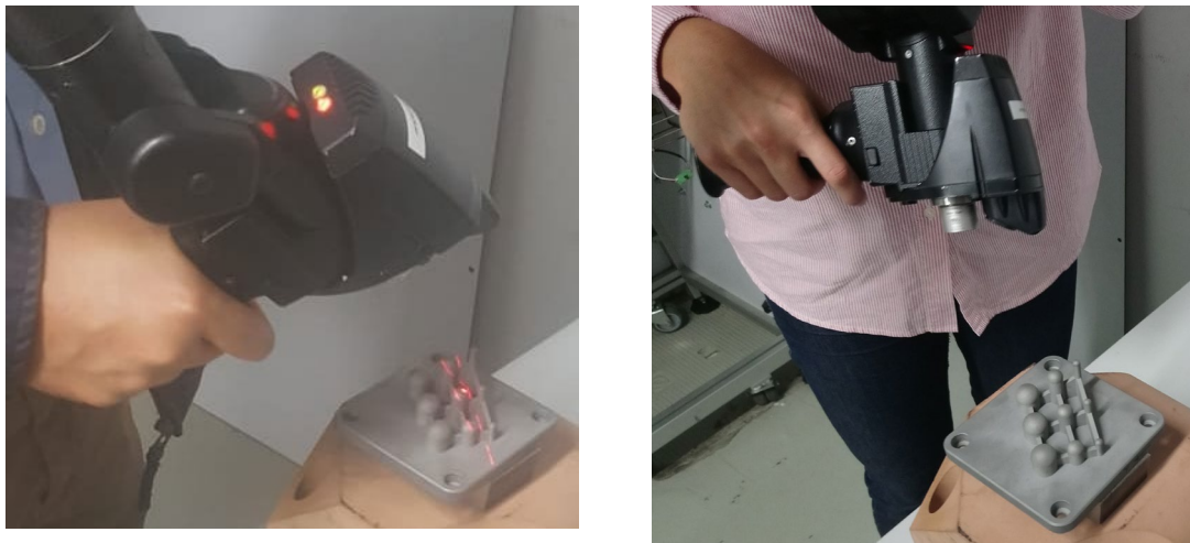
Figura 5. Escaneado con sensor de triangulación laser montado en Brazo de Medir por Coordenadas (AACMM)
