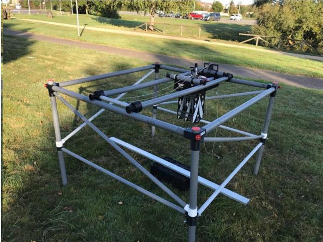
*Figura 1. Fotografía del setup portátil que emula el comportamiento del georradar embarcado en un dron. El carrito que está encima del setup contiene los elementos que conforman la carga útil del dron: georradar, receptor GNSS-RTK, controladora que iría embarcada en el dron, y micro-ordenador tipo Raspberry Pi.*
