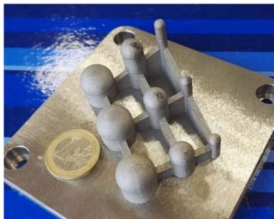
Fig. 3. Izq. modelos CAD finales diseñados para la investigación y nomenclatura de cubos y esferas. Der. modelos reales sinterizados por fusión láser de metal. (acabado en bruto, o “as built”).
