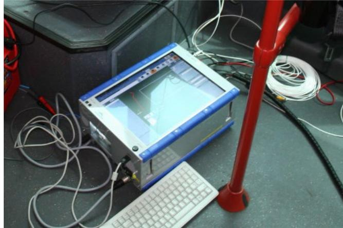
Fig. 4. Sistema de adquisición de datos DEWETRON (model DEWE3021).
