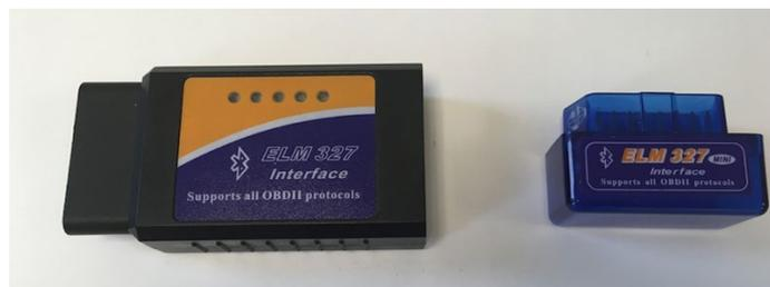
Fig. 2. Conectores OBDII ELM 327 Bluetooth empleados en el proyecto.
