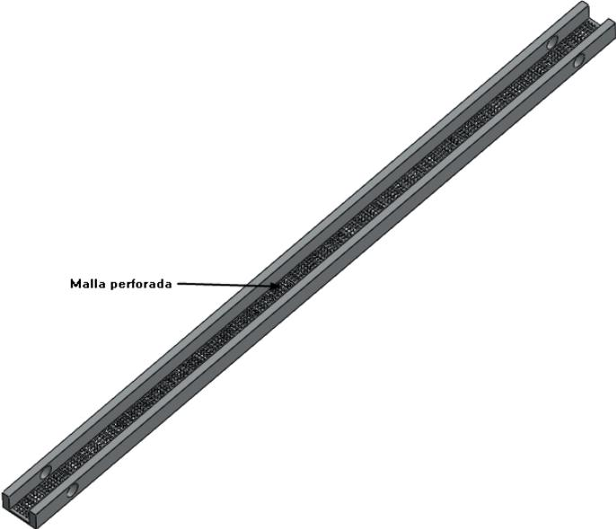
Figura 42. Soporte de la tubería con la malla perforada.
