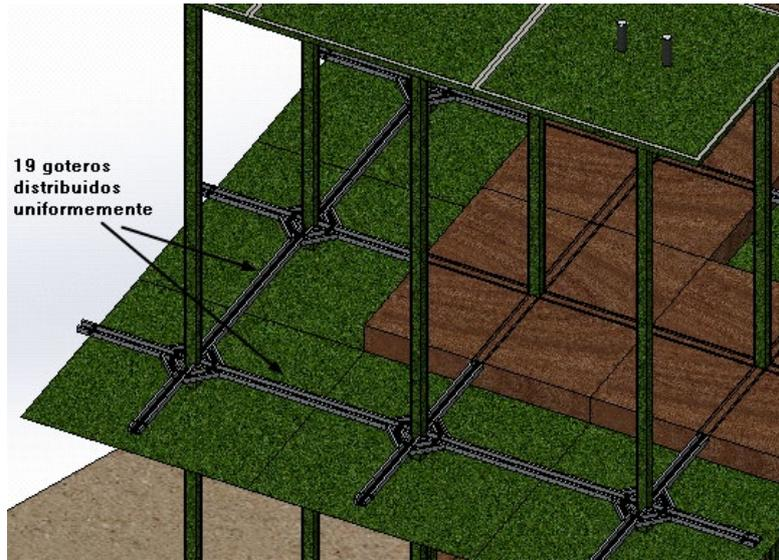
*Figura 30. 19 goteros necesarios en los extremos largos de los soportes de las tuberías*
