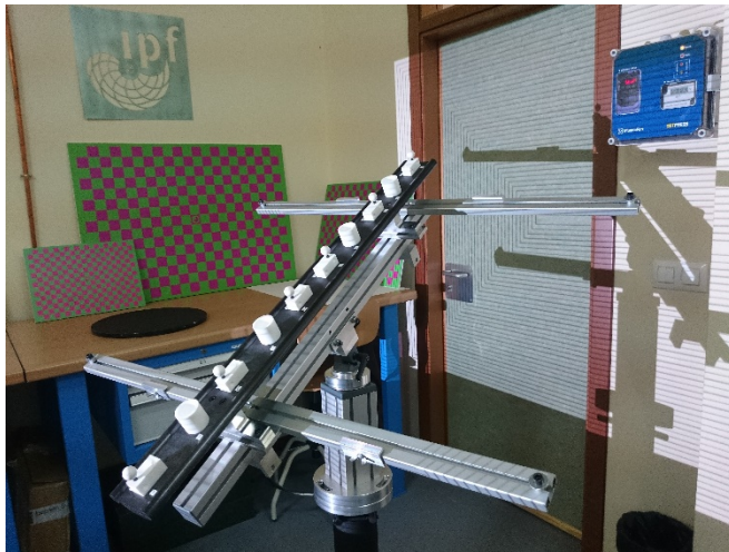
Fig. 8. Digitalizado del patrón de características mediante el equipo de luz blanca estructurada empleando múltiples orientaciones.
