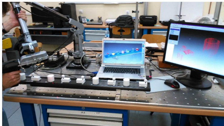
Fig. 6. Digitalizado del patrón de características mediante sensor láser. Ensayos preliminares para determinación de las estrategias óptimas.
