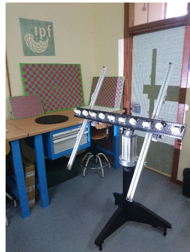
Fig. 8. Digitalizado del patrón de características mediante el equipo de luz blanca estructurada empleando múltiples orientaciones.
