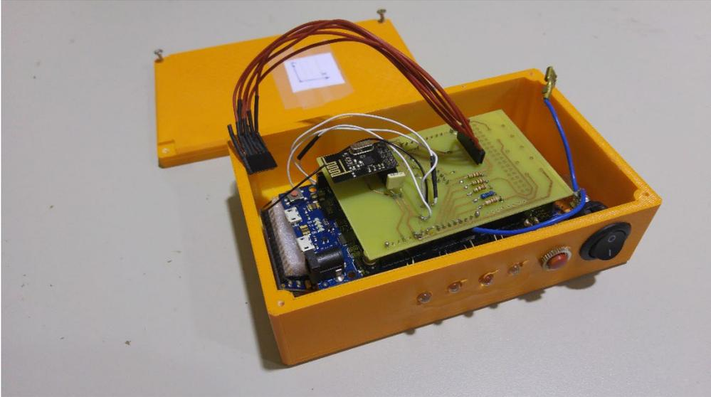
Figura 1. Unidad maestra para controlar la red de sensores (situada en la moto)
