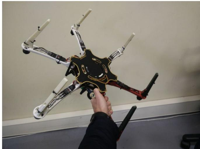
Finalmente se colocó la batería en la parte superior del RPA de manera que el centro de gravedad se mantuviese en el centro geométrico del RPA. Se utilizó velcro de alto agarre y se dispuso de un salvalipo con zumbador al lado para indicar el nivel de voltaje y emitiese ruido a determinado nivel de tensión.
