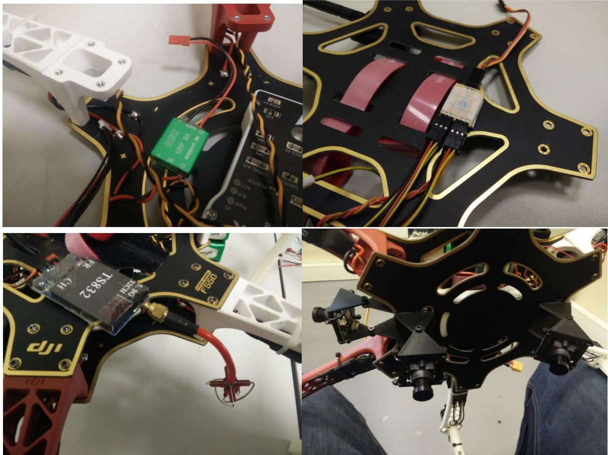
El siguiente consistió en la instalación de la telemetría en el RPA, para ello se emparejaron el módulo de emisión con el de recepción a través del Mission Planner. El proceso de emparejamiento se hizo en la ventana Sik Radio (Initial setup - Optional Hardware - Sik Radio), estando ambos módulos alimentados, se pulsó Load Settings y una vez el Mission Planner leyó los parámetros se procedió a comprobar que tanto el módulo de emisión como el de recepción tuvieran los mismos valores.
