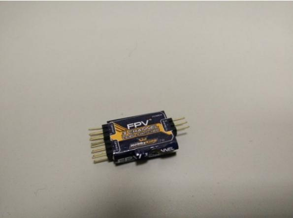
Ya que la batería principal que alimenta el RPA es 4S se necesitó el regulador de tensión de 12 V debido a que tanto el transmisor de vídeo como las 3 cámaras CCD se alimentan a 12 V.
