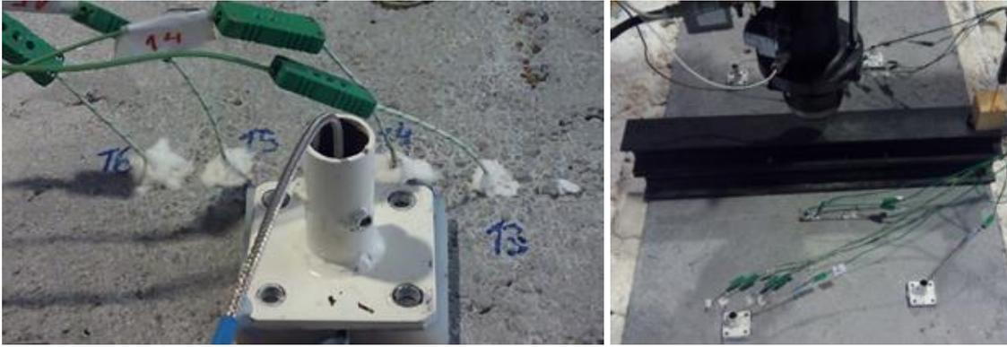
Figura 10. Sensores de temperatura (izquierda) y aplicación y distribución de la carga (derecha)
