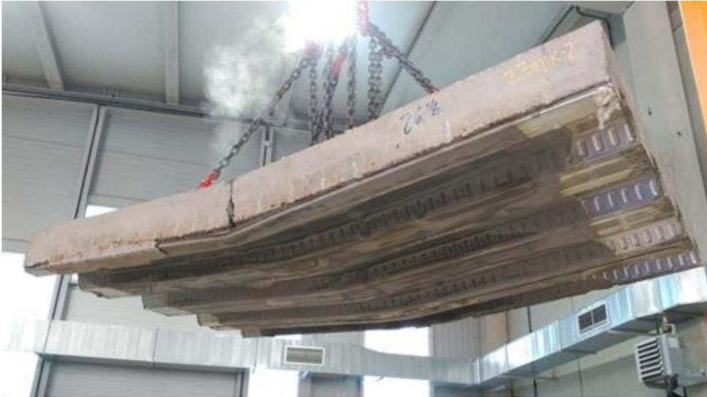
Figura 21. Estado de la losa HLE LSDur-23 mk2 tras la realización del ensayo.
