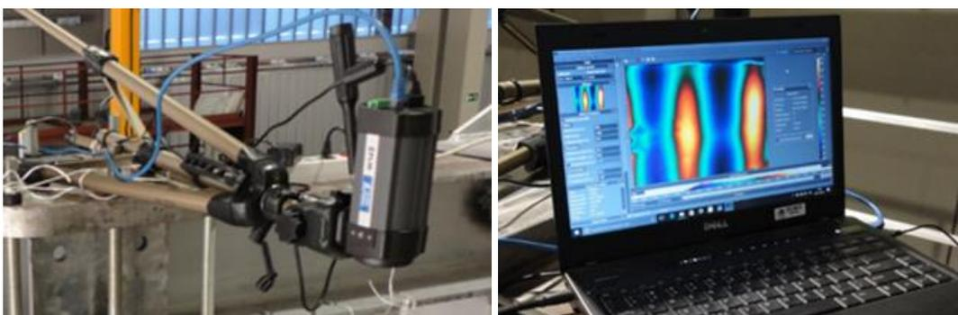
Figura 12. Detalle de la cámara termográfica empleada (izquierda) y visualización de la imagen térmica captada durante el ensayo (derecha).
