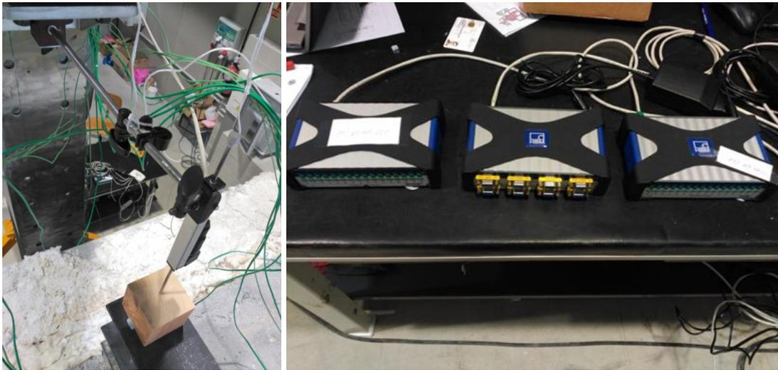
Figura 11. Detalle del transductor de desplazamiento (izquierda) y equipos utilizados para el registro de datos (derecha)
