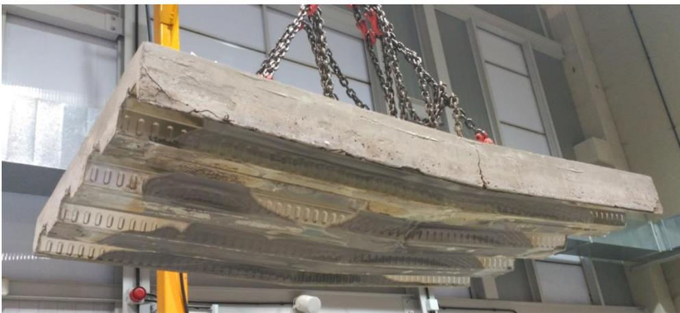
Figura 22.- Estado de losa HN-2 tras la finalización del ensayo.
