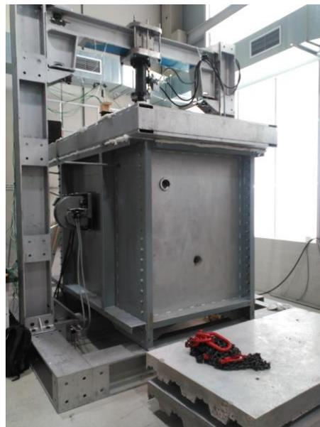
Figura 1. Horno utilizado para la realización de los ensayos (Localización: Edificio De Servicios Comunes de Investigación, E.P.I. de Gijón)
