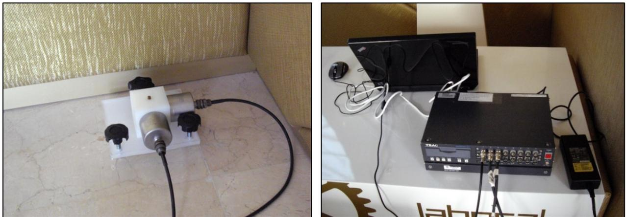
Figura 2. Sensores de aceleración (izquierda) y sistema de adquisición (derecha) utilizados en los ensayos.
