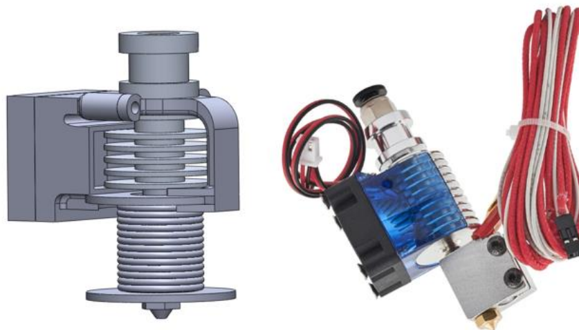
Figura 4 · A la izquierda, el diseño del primer prototipo de extrusor por inducción, a la derecha, el extrusor comercial Volcano.
