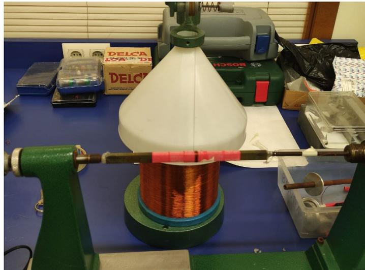
Como primer paso y para una familiarización del estudiante contratado con el equipo de medida, se midieron muestras masivas de acero facilitadas por la empresa colaboradora ArcelorMittal, sometidas a distintos tratamientos térmicos a diferentes temperaturas. Este paso requirió el bobinado de circuitos secundarios adaptados a la geometría de las muestras, mediante la máquina bobinadora que se muestra en la figura 1.
