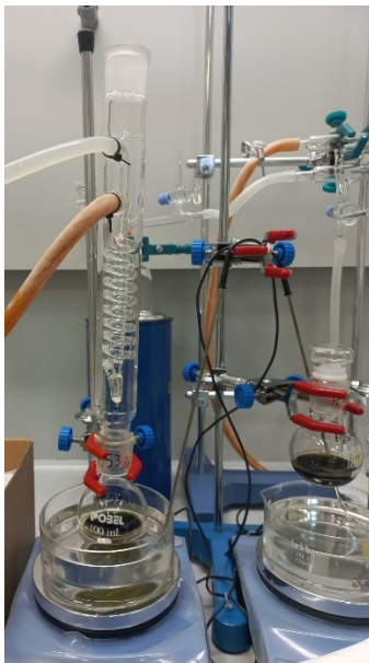
Figura 5. Dispositivo para las reacciones de transesterificación.
