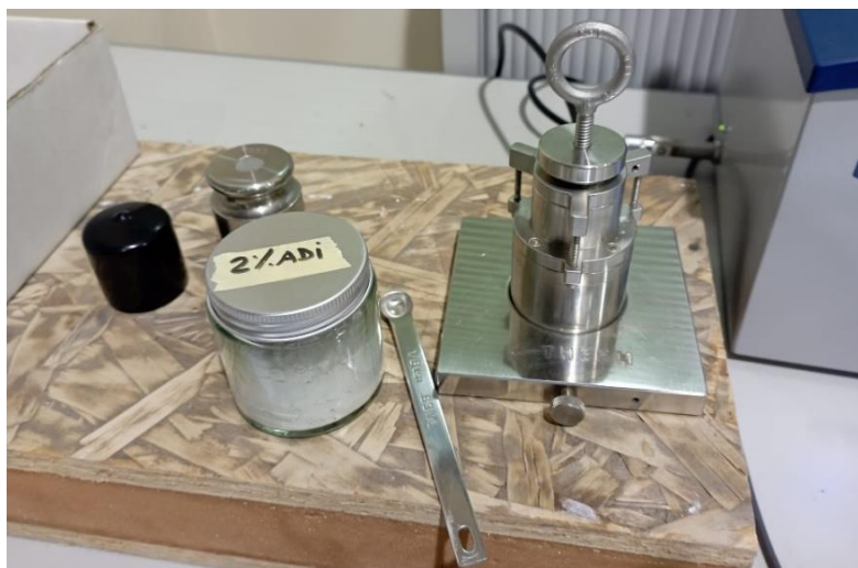
Figura 12. Detalle de la instalación para la medida de la conductividad en la mezcla 2% adición
