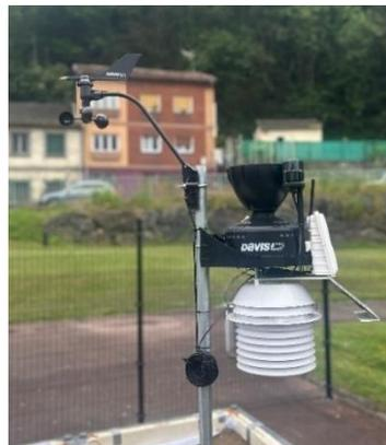
*Figura 4 Estación meteorológica completa instalada (Fuente: elaboración propia)*
