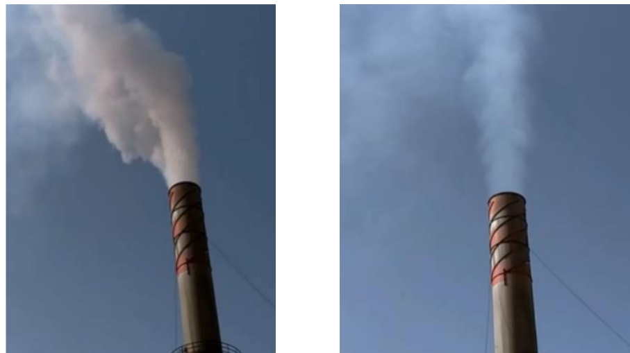
Figura 2. Aspecto visual del penacho antes (izquierda) y después (derecha) de la implantación de la tecnología
