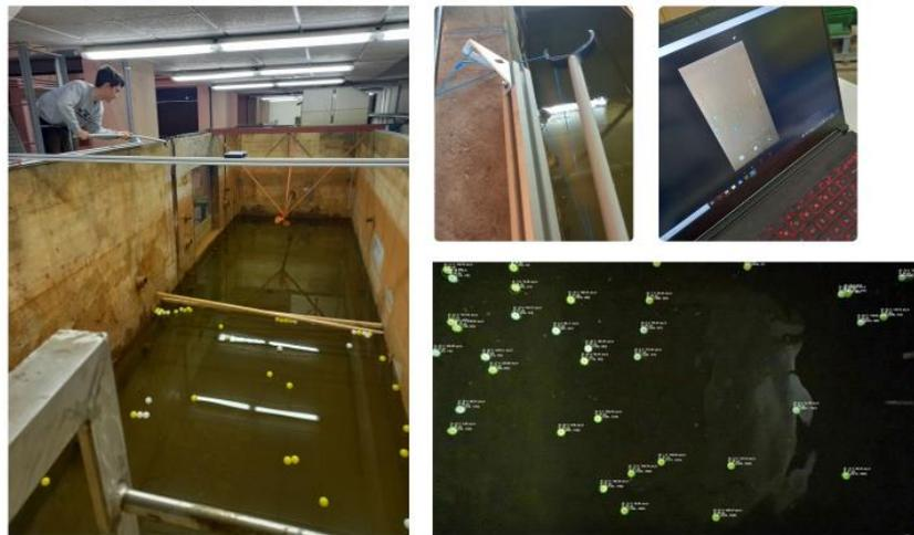
Figura 5. Preparación del ensayo e identificación de las bolas mediante redes neuronales
