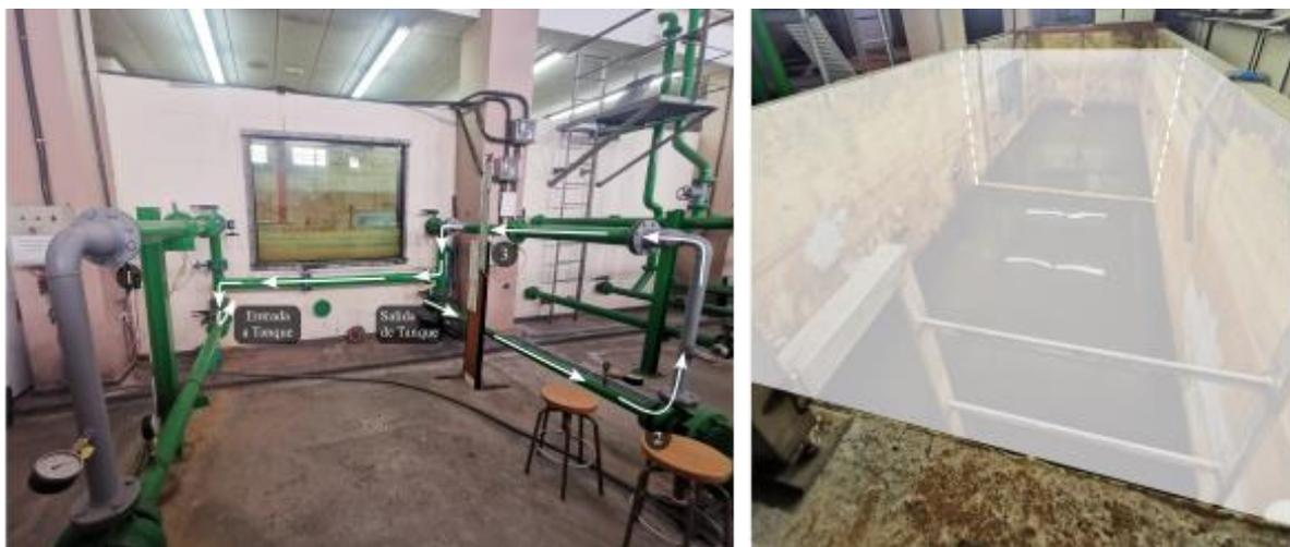
Figura 1. Tanque de ensayos: Configuración de las tuberías y delimitación de la zona de ensayo
