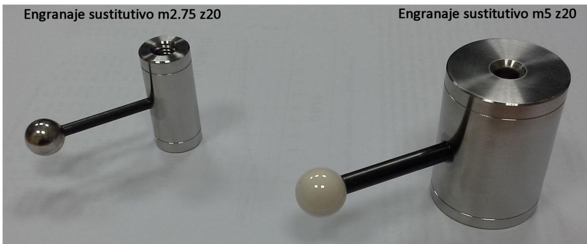
Fig.2.- Patrones de geometría sustitutoria para dientes de engranajes
