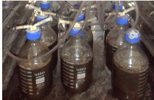
Figura 2. Botellas de 2 litros de capacidad empleadas en los ensayos de biodegradabilidad.
