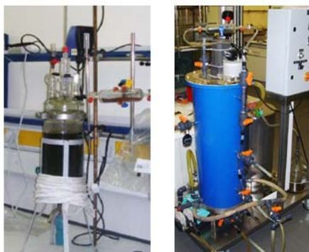
Figura 4. Tipos de reactor utilizados en los ensayos de digestión anaerobia en continuo: CSTR (izq.) e IBR (dcha.)
