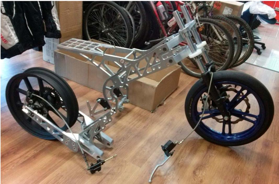
Figura 2. Bastidor sin el grupo motopropulsor (retirado para la puesta a punto del motor)
