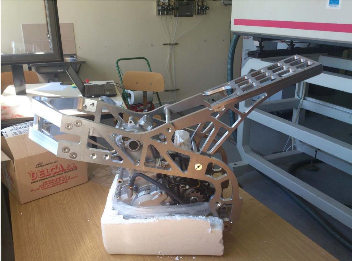
Figura 2. Bastidor con el grupo motopulsor
