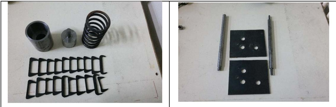
Figura 1. Garras y copas para el cambio de muelles y piezas para la plantilla de soldadura
