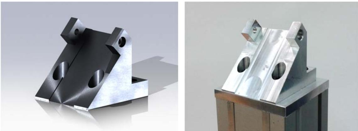
Figura 5. Piezas de sujeción para el patrón a  $45^\circ$ .
