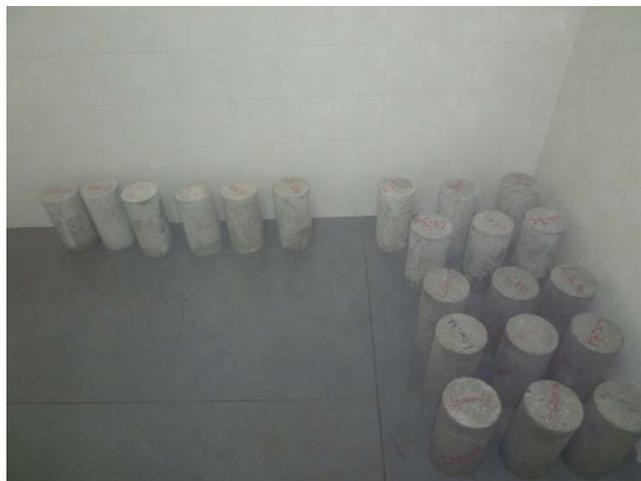
Figura 4. Probetas de HLE en el interior de la cámara higrotérmica.
