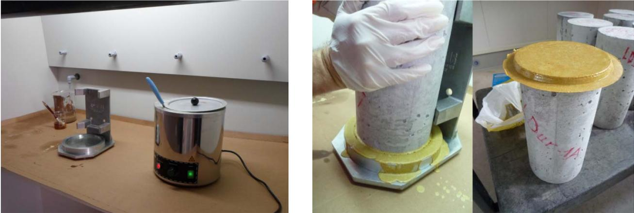
Figura 5. Proceso de refrentado: utensilios utilizados (izquierda); proceso de refrentado y probeta fina (derecha)
