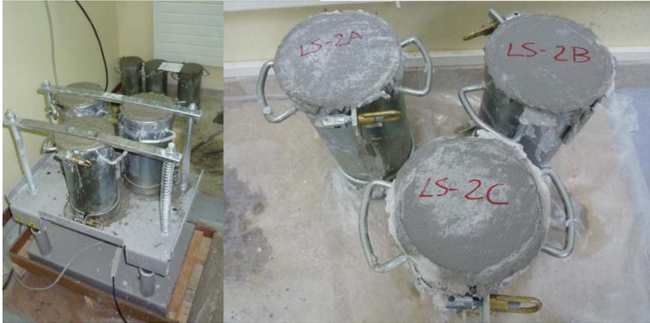
Figura 2. Elaboración de las probetas. Procedimiento de vibrado (izquierda); tiempo de curado en molde de 3 muestras (derecha)
