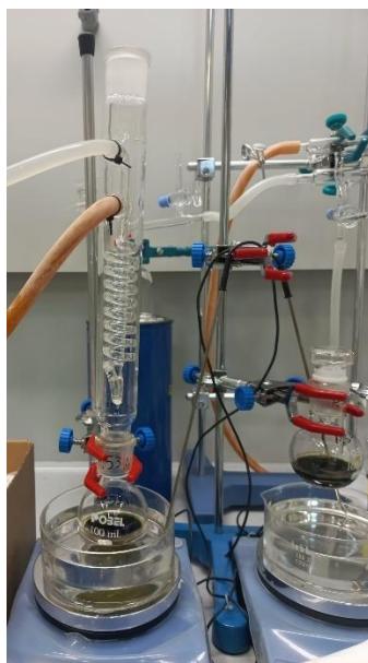
Figura 5. Dispositivo para las reacciones de transesterificación.
