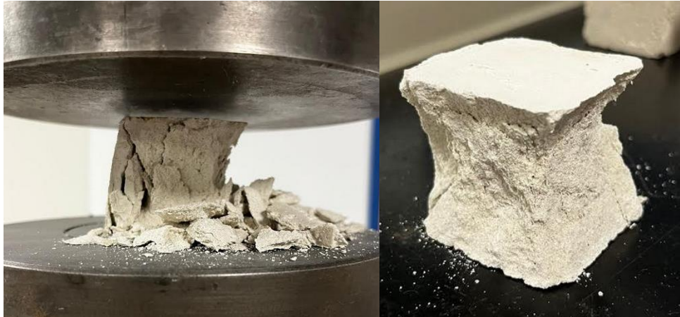
Figura 9. Ensayos a compresión de las mezclas
